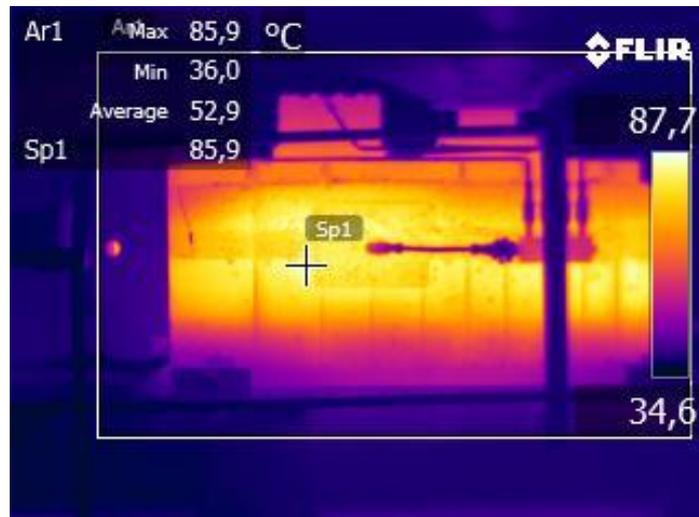
**Figura 12:** Termografia lateral de um redutor de uma célula de resfriamento. (BRASKEM, 2018).
