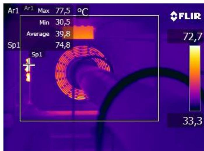
**Figura 13:** Termografia frontal de um redutor de uma célula de resfriamento. (BRASKEM, 2018)
