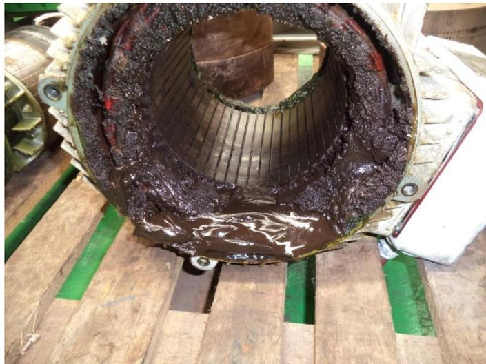
**Figura 34:** Enrolamento do motor com excesso de graxa. (BRASKEM, 2018)
