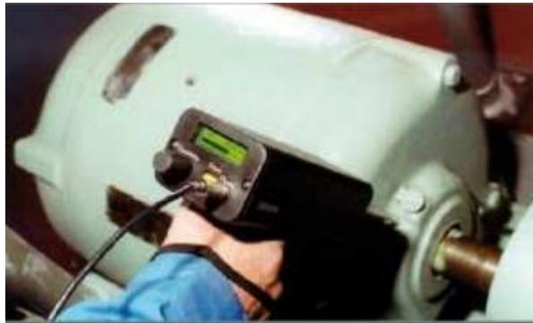
**Figura 1:** Medição de mancal com Ultraprobe 9000 ATEX. (UE SYSTEM, 2004)
