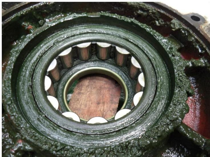
**Figura 35:** Rolamento do motor com excesso de graxa. (BRASKEM, 2018)
